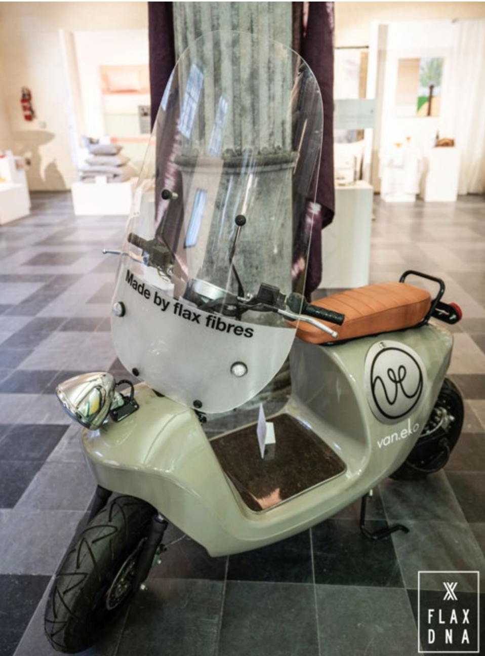
Figuur 2: scooter uit vlasvezel en biogebaseerd hars
