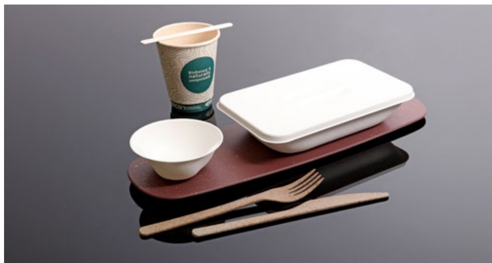
Figuur 4: gespuitsgiete producten op basis van korte vlasvezel en biogebaseerd materiaal (i.s.m. Guru Plastics en De Ster)
